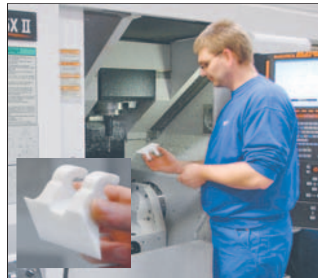
Maskinarbejder Kenn Schmidt har netop programmeret dette emne, som i dag fremstilles i to opstillinger mod tidligere fem.
